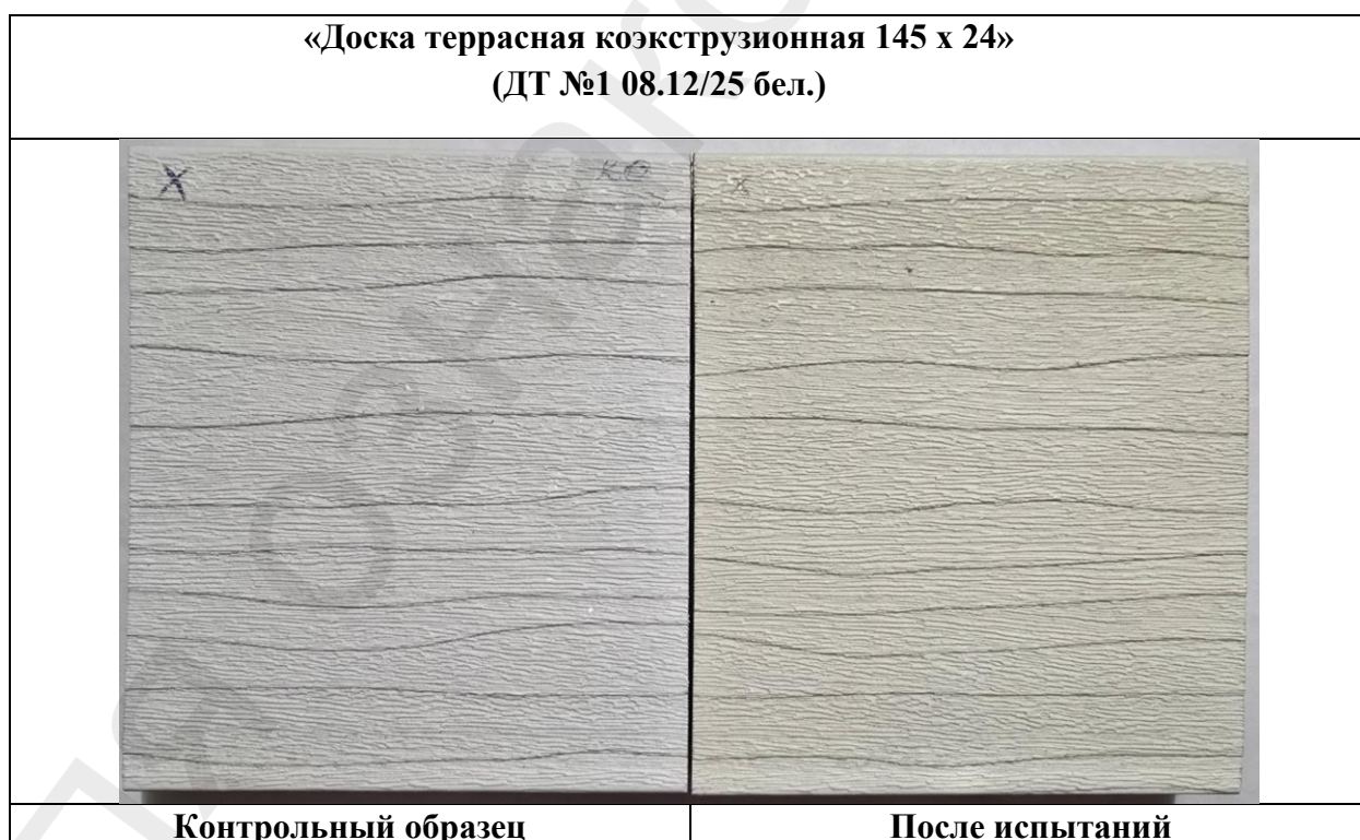
Рис.1 – «Доска террасная коэкструзионная 145 x 24» (ДТ №1 08.12/25 бел.) после циклических испытаний
